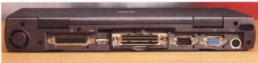
I connettori sul retro. Da notare l'uscita della ventolina sulla destra, la porta USB al centro (vicino al connettore per la *docking station*) e la IrDA in alto a destra.
